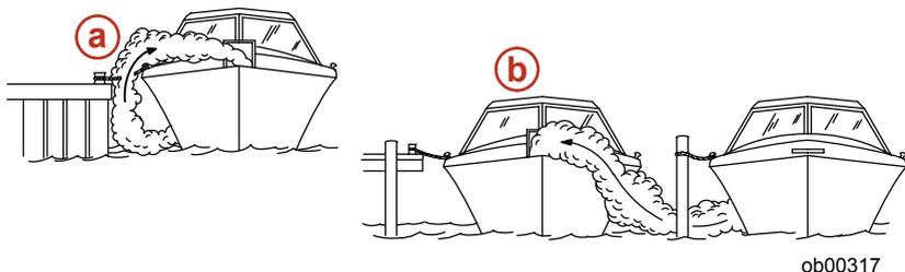
**a-** Работа двигателя, когда катер пришвартован в закрытом пространстве.
