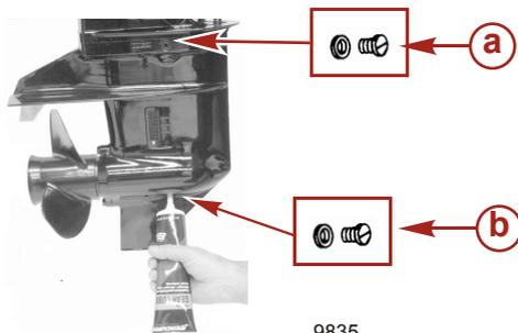
**a -** Заглушка вентиляционного отверстия и уплотнительная шайба
