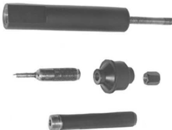
комплект установщика пружин для стартера 50068
