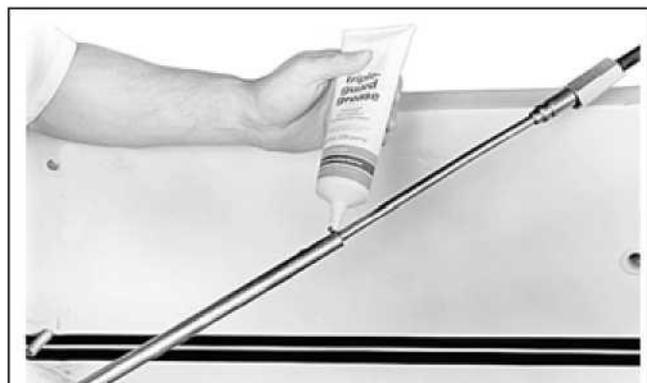
Механический рулевой кабель, одобренный АВУС. 5873
