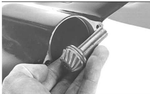
**ВАЖНО:** Если шестерня стопорится при сборке, поверните переднюю шестерню, чтобы обеспечить зацепление. Если привязка все еще присутствует, передняя стойка подшипника неправильно установлена.
