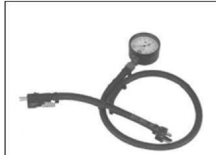
Топливный вакуумный тестер P/N 390954 23286
